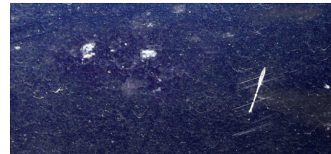
Erscheinungsbild einer ungeschützten Lackfläche
